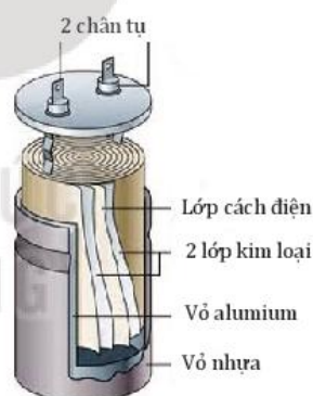
Hình 21.5. Cấu tạo của tụ điện hình trụ
