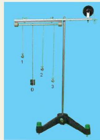
Hình 6.3. Thí nghiệm về dao động cưỡng bức
