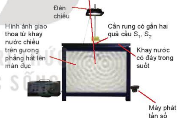
Hình 12.1. Thí nghiệm tạo ra sự giao thoa của hai sóng nước
