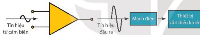
Hình 9.1. Sơ đồ khối mạch tạo tín hiệu điều khiển thiết bị.
