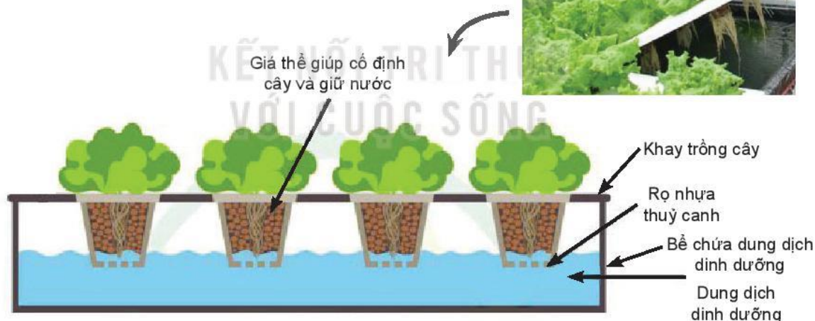
Hình 25.3. Hệ thống thủy canh không hồi lưu
