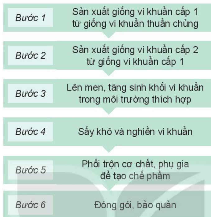
Hình 18.1. Các bước sản xuất chế phẩm vi khuẩn trừ sâu
