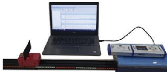
Hình 6.8. Đo tốc độ bằng cảm biến chuyển động
