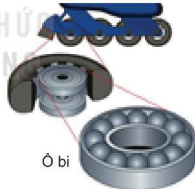
Hình 18.6. Con lăn hoặc ổ bi đặt xen giữa vào hai mặt tiếp xúc
