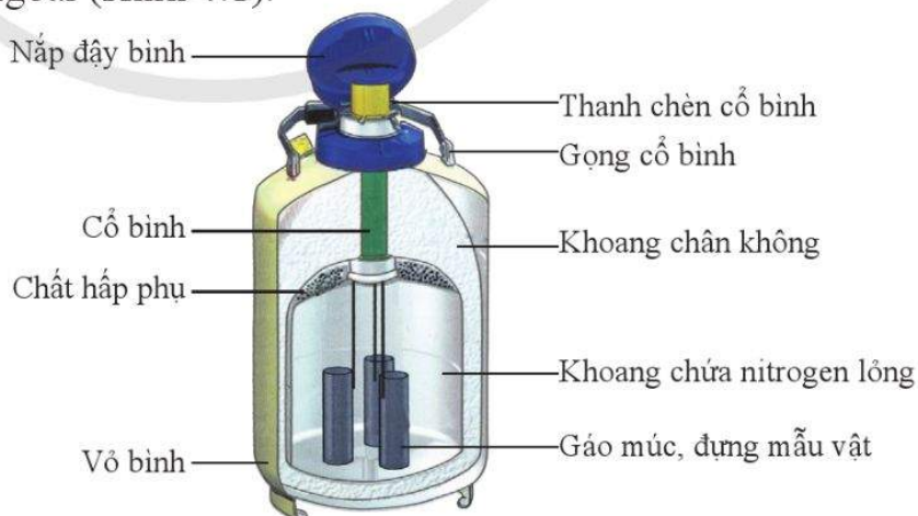
Hình 4.1. Cấu tạo của bình bảo quản mẫu vật bằng nitrogen lỏng
