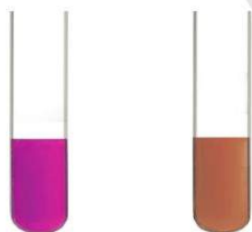
Hình 13.5. Ống nghiệm chứa dung dịch potassium permanganate trước (a) và sau khi được sục khí ethylene (b)
