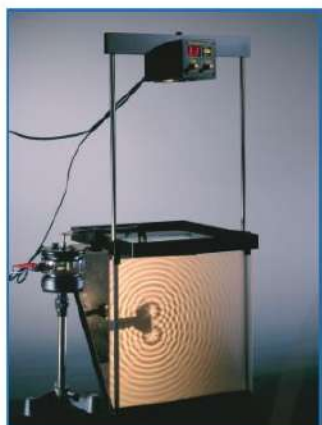
Hình 3.5. Thí nghiệm chứng minh sự giao thoa của hai sóng mặt nước kết hợp
