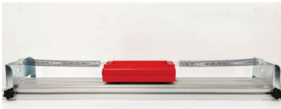
Hình 1.6. Thí nghiệm chuyển động của xe kỹ thuật số
