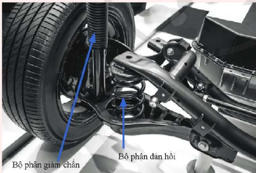
Hình 4.3. Bộ phận đàn hồi và bộ phận giảm chấn trong hệ thống treo của ô tô
