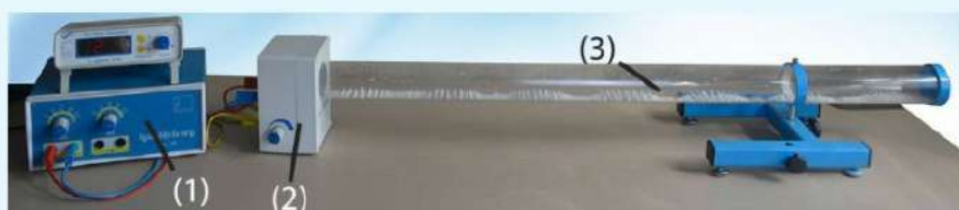
Hình 4.6. Sóng dừng trong ống cộng hưởng tạo bởi sóng âm tần số f và sóng phản xạ của nó
