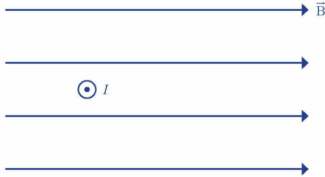
▲ Hình 10.5. Đoạn dây dẫn thẳng mang dòng điện đặt trong từ trường đều
