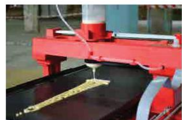
Hình 9.7. Máy in 3D sử dụng công nghệ LDM
