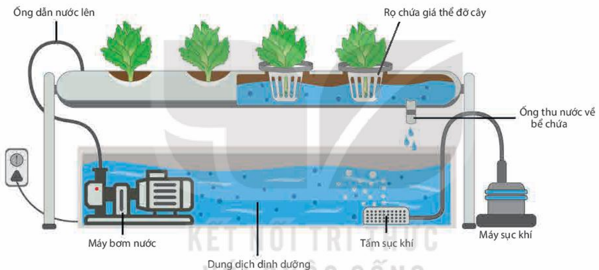
Hình 2.2. Sơ đồ cấu trúc mô hình thủy canh
