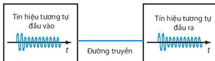
Hình 5.4. Truyền dẫn bằng tín hiệu tương tự
