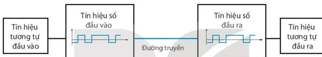
Hình 5.5 Truyền dẫn bằng tín hiệu số
