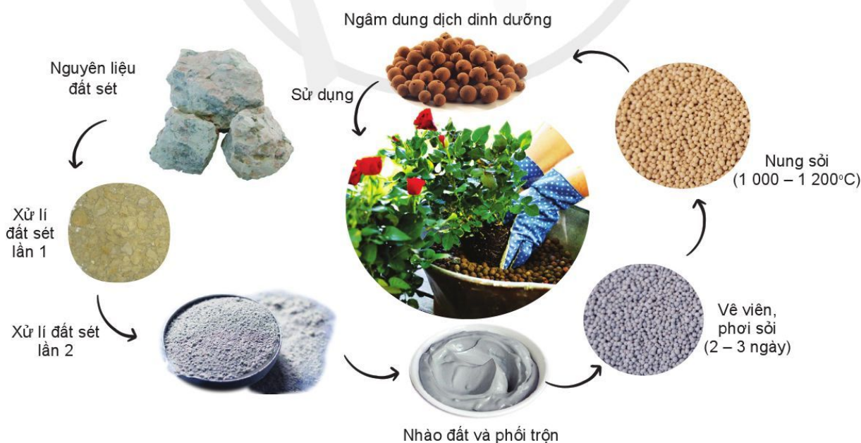
Hình 6.5. Quy trình sản xuất sỏi nhẹ Keramzit
