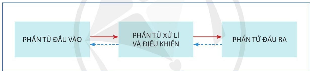
Hình 2.2. Cấu trúc của hệ thống kỹ thuật
