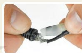
c) Dây điện bị sờn
