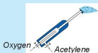
Hình 15.1. Sơ đồ cấu tạo đèn xì oxygen – acetylene
