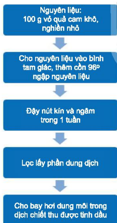
Hình 4.2. Sơ đồ tách tinh dầu vỏ cam bằng phương pháp ngâm chiết
