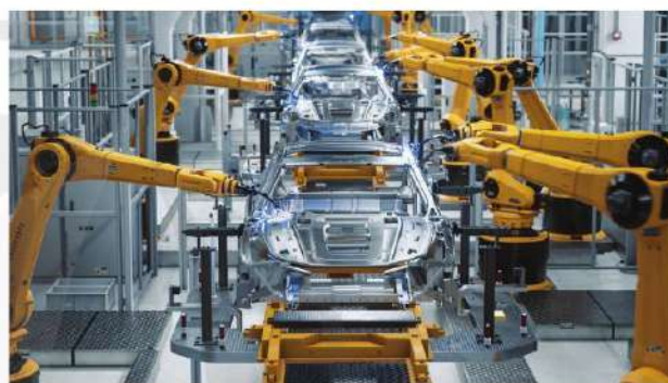
Hình 5.3. Dây chuyền lắp ráp ô tô bằng robot
