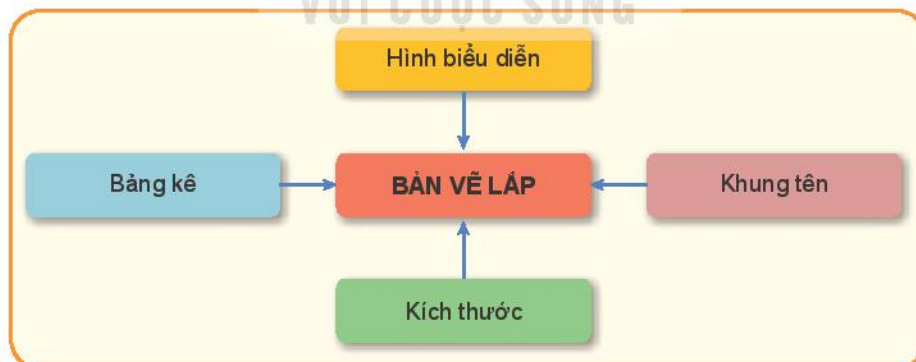
Hình 4.2. Sơ đồ nội dung bản vẽ lắp
