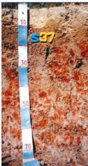
Hình 21.4. Mặt cắt thẳng đứng qua các tầng đất của đất fe-ra-lit đỏ vàng trên đá phiến sét
