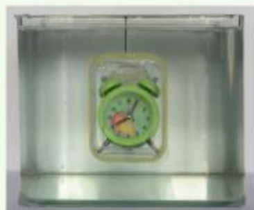
Hình 9.8. Thí nghiệm chứng tỏ âm truyền trong chất lỏng
