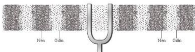
Hình 9.5. Minh họa sự nén, giãn không khí được truyền đi khi âm thoa dao động
