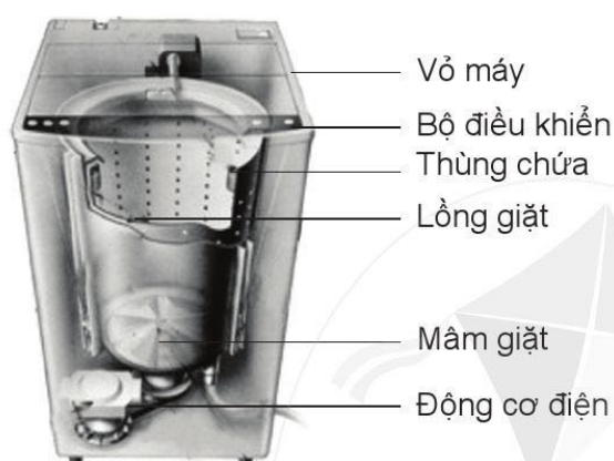
Hình 14.5. Cấu tạo của máy giặt
