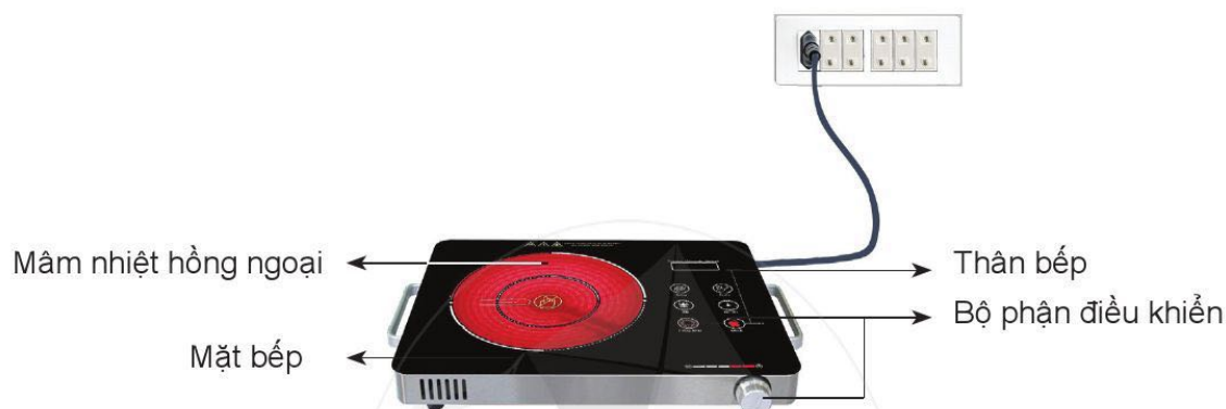
Hình 13.4. Cấu tạo của bếp hồng ngoại
