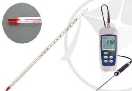
Hình 13.2. Nhiệt kế đo nhiệt độ nước
