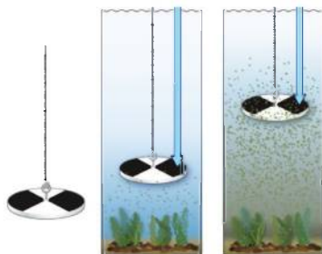
Hình 13.3. Đĩa Secchi đo độ trong của nước
