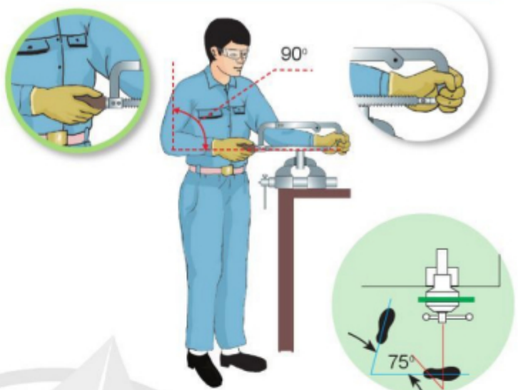
Hình 7.3. Cách cầm cưa và tư thế đứng cưa
