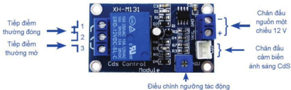
Hình 14.2. Chân đầu nối của mô đun cảm biến ánh sáng CdS
