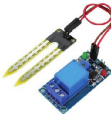
Hình 13.9. Mô đun cảm biến độ ẩm của đất
