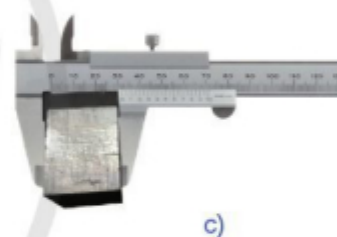
Hình 7.16. Kẹp phôi, kiểm tra mặt phẳng, kích thước sản phẩm
