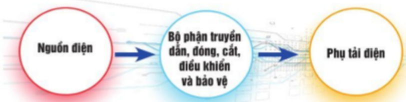
Hình 12.2. Sơ đồ khối cấu trúc chung của mạch điện
