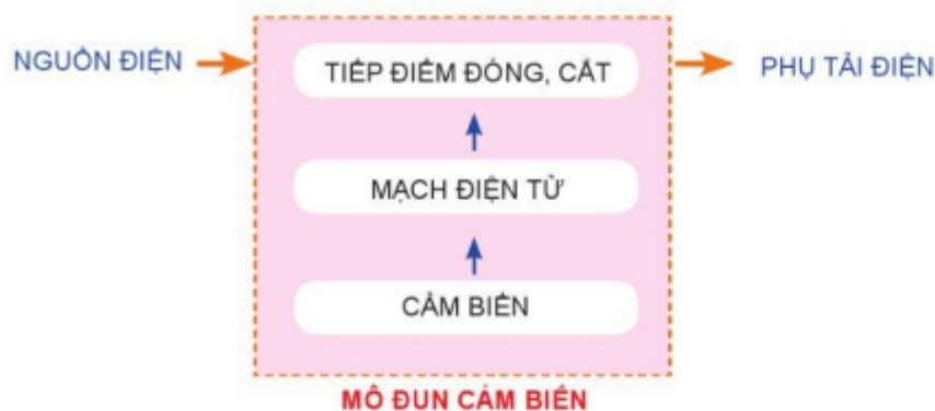
Hình 13.4. Sơ đồ khối mạch điện điều khiển sử dụng mô đun cảm biến
