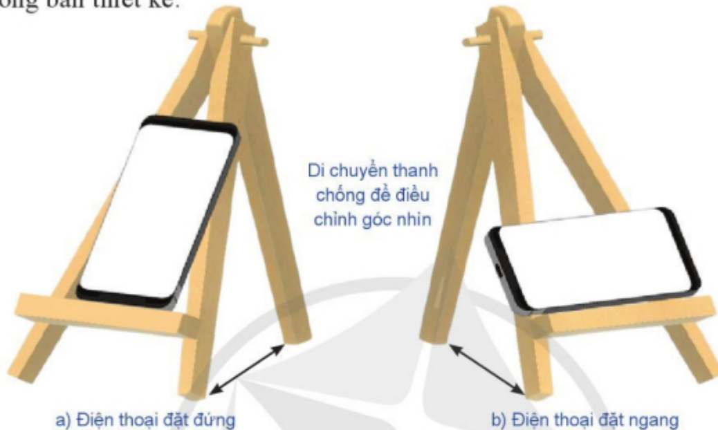
Hình 17.6. Thử nghiệm giá đỡ điện thoại mẫu
