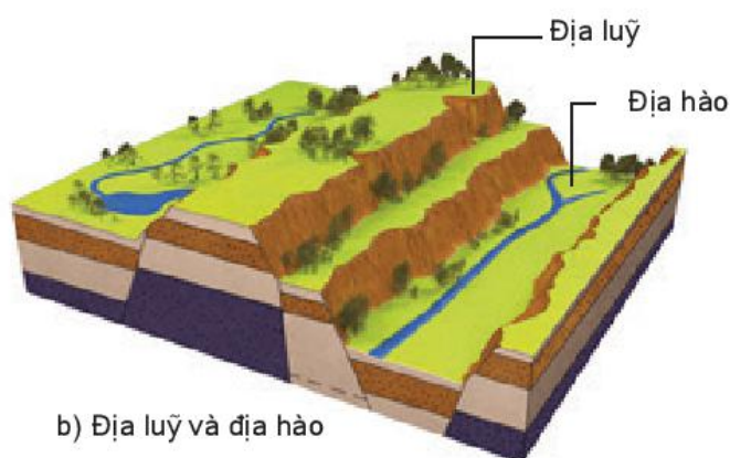
Hình 7.1. Hiện tượng uốn nếp và đứt gãy
