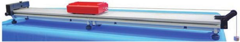
Hình 1.2. Thí nghiệm khảo sát liên hệ giữa lực và gia tốc
