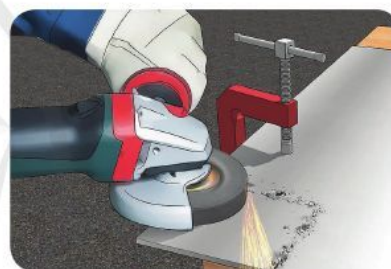
Hình 1.4. Các mảnh vụn sắt văng ra theo phương tiếp tuyến.
