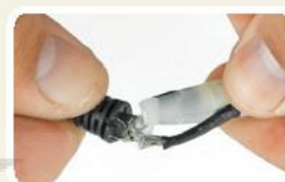
c) Dây điện bị sờn
