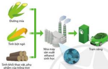
Hình 20.4. Sơ đồ quy trình sản xuất ethanol sinh học từ phụ phẩm nông nghiệp nhờ nấm men Sacharomyces cerevisiae
