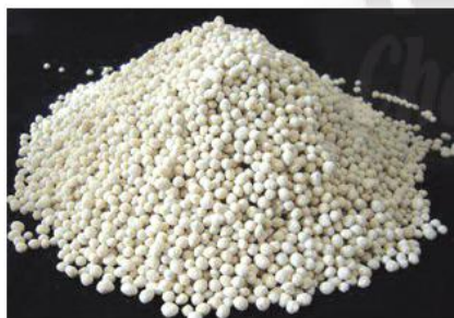
Phân ammophos là hỗn hợp các muối \text{NH}_4\text{H}_2\text{PO}_4 và (\text{NH}_4)_2\text{HPO}_4 (a) Phân bón phức hợp
