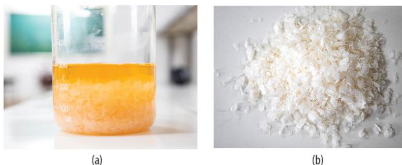
▲ Hình 6.8. Chitin được tẩy trắng bằng \text{H}_2\text{O}_2 (a) và chitin sạch (b)
