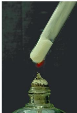
▲ Hình 4.6. Sự phân huỷ nhiệt của \text{NH}_4\text{Cl}
