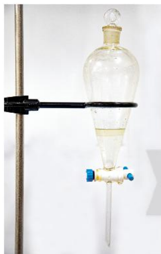
▲ Hình 9.2. Chiết tinh dầu quýt và nước
