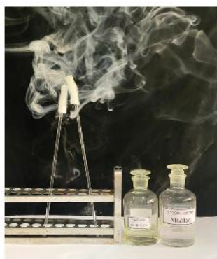
▲ Hình 4.3. \text{NH}_3 tác dụng với \text{HCl}
