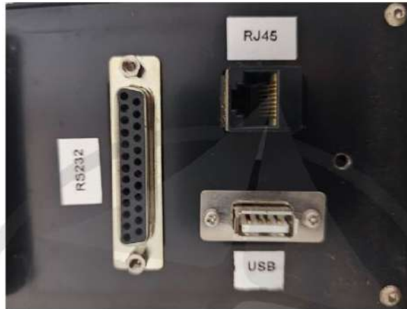
Hình 6.4. Thiết bị đầu vào trên máy CNC
