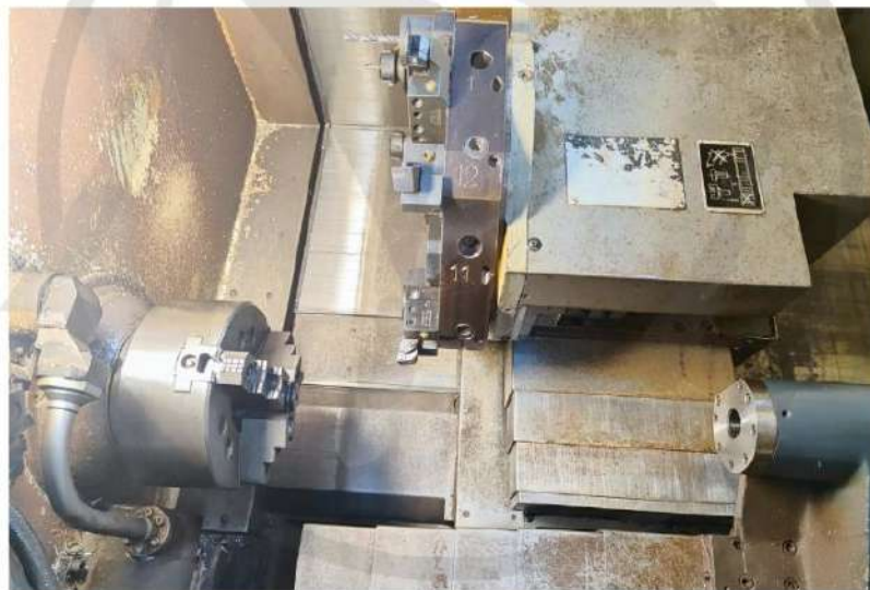
Hình 6.6. Bộ phận chấp hành của máy tiện CNC
