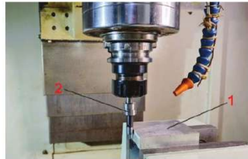
Hình 8.7. Cài đặt gốc phôi bằng đầu dò cơ khí 1. Phôi; 2. Đầu dò cơ khí.
