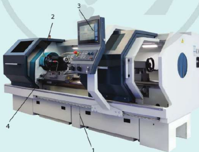
Hình 7.7. Một số bộ phận của máy tiện CNC
