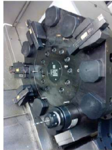
Hình 7.6. Cơ cấu tích dao kiểu Revolve của máy tiện CNC
