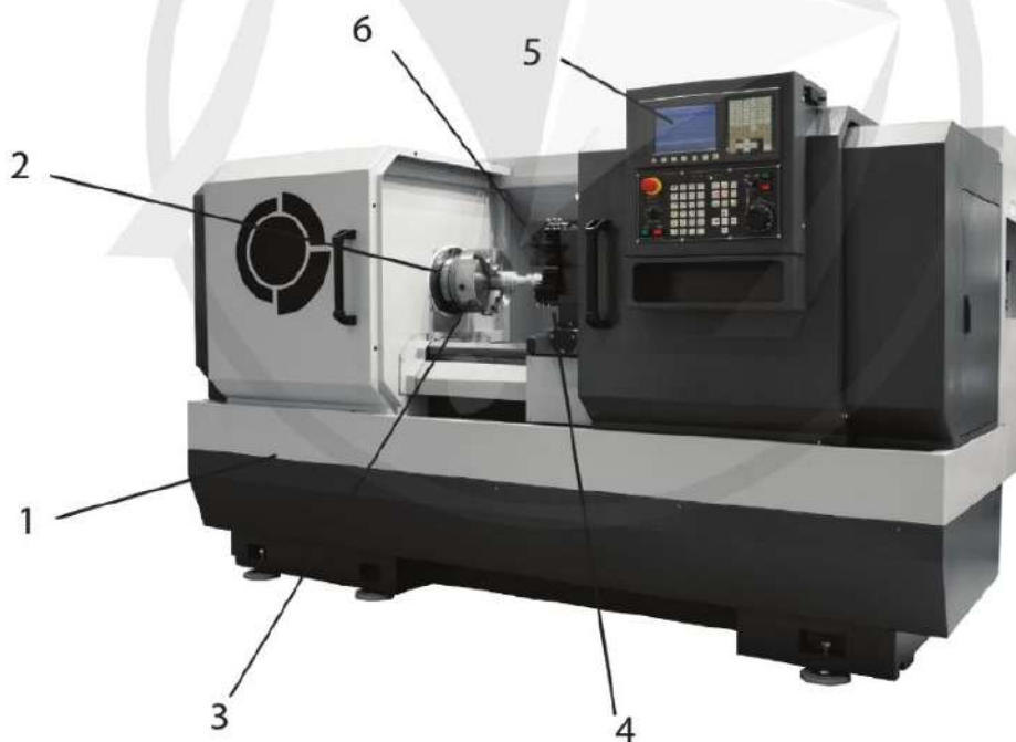
Hình 7.1. Cấu tạo của máy tiện CNC
