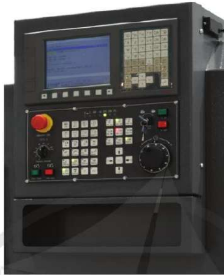
Hình 6.7. Bộ phận hiển thị của máy CNC
