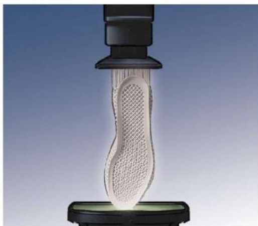
Hình 11.4. Đế giày có cấu trúc lưới được tạo bằng công nghệ in 3D
