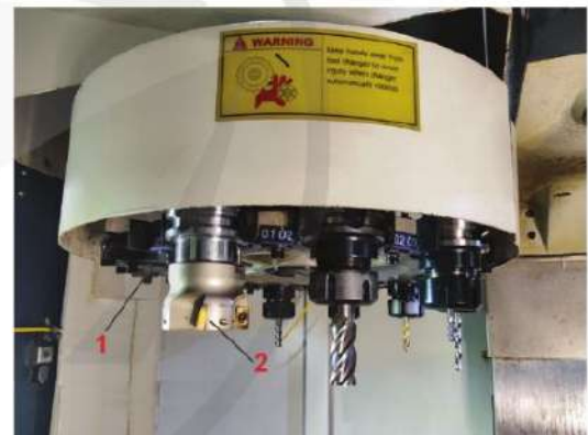
Hình 8.8. Gá lắp dao trên cơ cấu tích dao Revolve 1. Ổ tích dao Revolve; 2. Dao.
