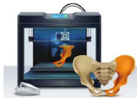
Hình 9.4. Mô phỏng chế tạo xương chậu bằng công nghệ in 3D
