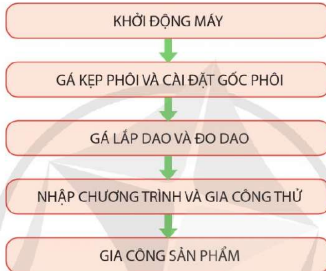
Hình 8.1. Quy trình gia công trên máy CNC
