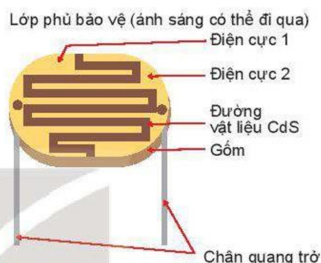
Hình 5.8. Cấu tạo của quang trở
